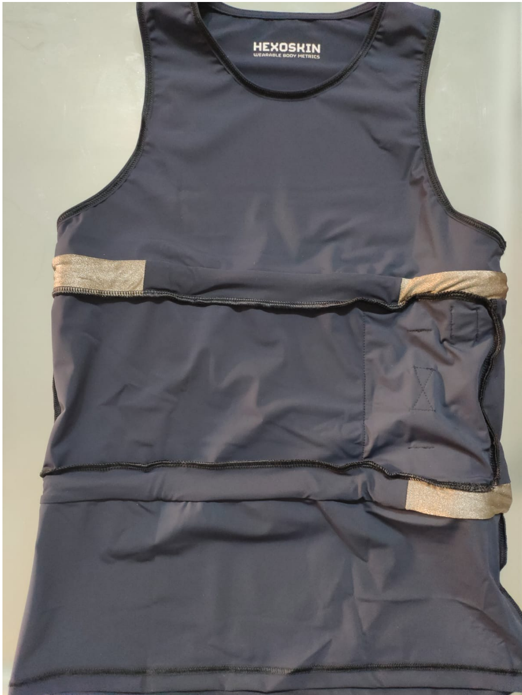
Figura 6. Vista interna del wearable di Hexoskin
