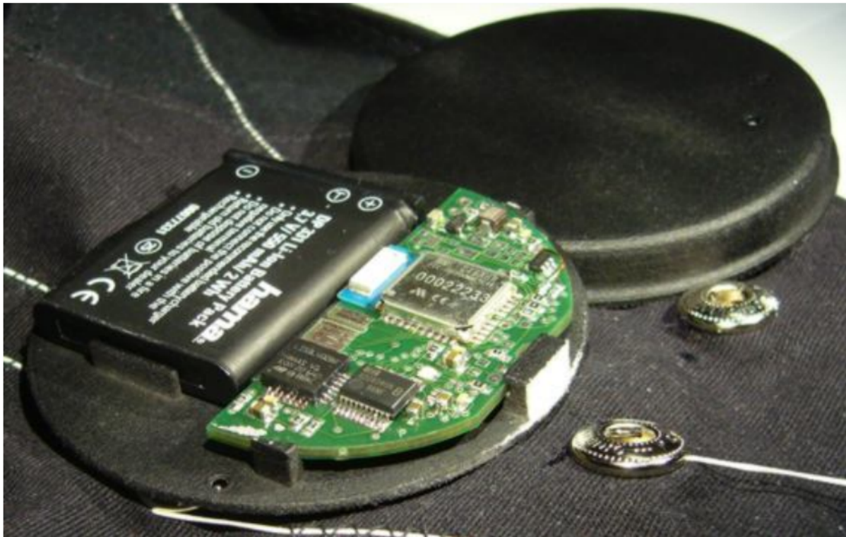
Figura 4. Modulo principale della componente elettronica
