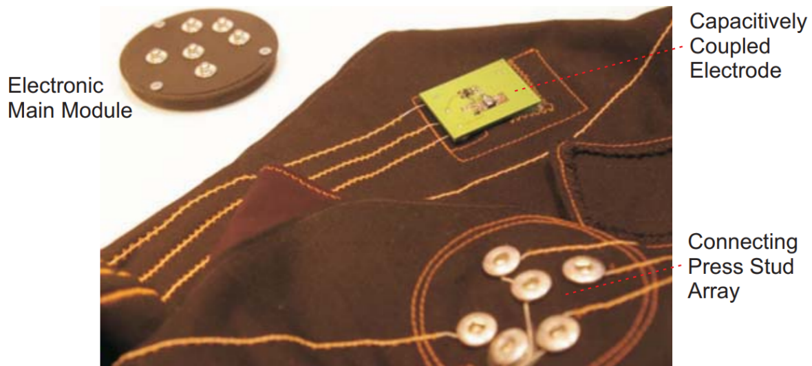
Figura 1. Panoramica del sistema wearable proposto nel lavoro di Fuhrhop et al. [1]
