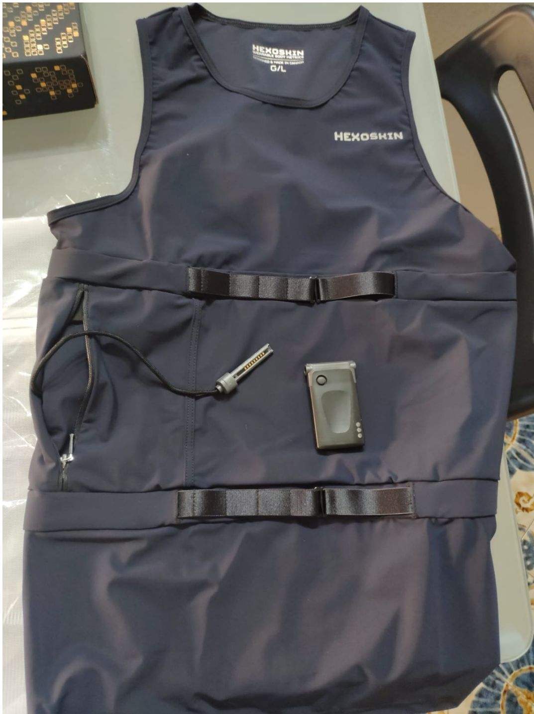
Figura 8. Dettaglio della tasca e del connettore del wearable di Hexoskin
